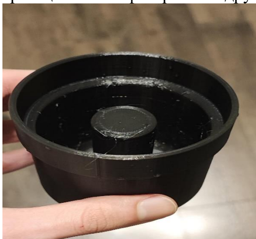
Рисунок 2 – образец чаши Пифагора, созданный при помощи 3D-принтера.
